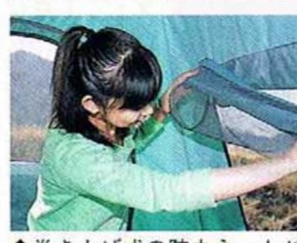
●2本のダンパーにより、テントは後部を軽く押し上げるだけでワンタッチで開けることができる。閉じるときはグリップ付きのロープでルーフを引き下げ、膨らんだテント地を屋根の内側に押し込んで後部をロックするだけだ。
