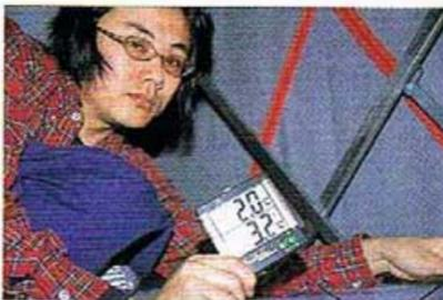
● 室内温度は枕元で、室外温度はクルマのルーフとルーフテントの間にセンサーを置いて計測。温度差については、左の表を見てね!
