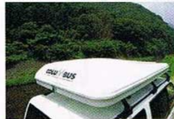
② はみ出たテントの布地を内部に収め、フックをかければ終了。これだけですぐに釣り場へ行ける! 収納時の厚みはわずか30cmほど。内部にサオなどを入れておき、ルーフボックスとして使用することも可能
