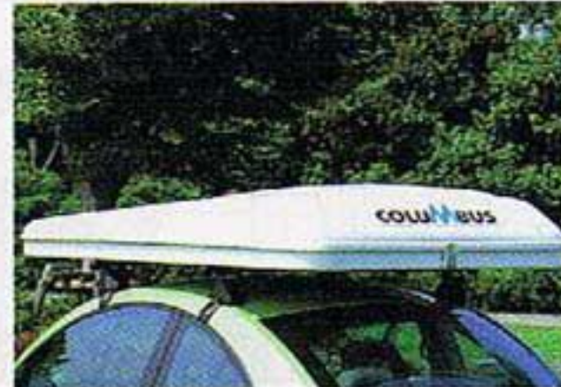
↑後方のロックを解除し、軽く持ち上げると、バネの力でポップアップ。収納時はロープを引く。
